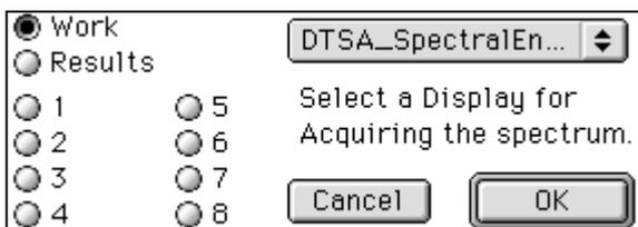
DTSA は 10 個のスペクトルを同時に表示できる。このメニューは、測定したスペクトルを表示するメモリを選択する。
